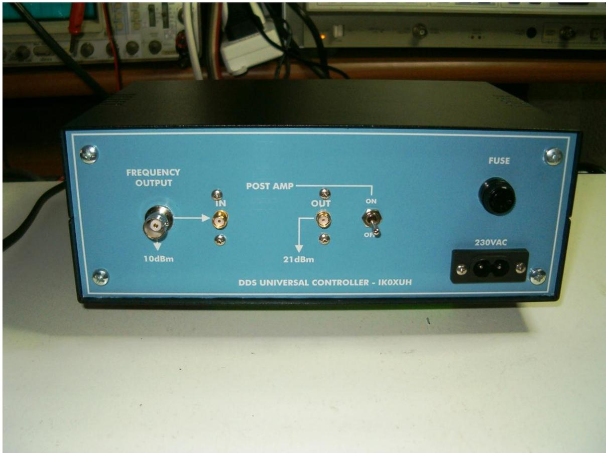
Figura 2 - Vista del pannello posteriore con Post-AMP
